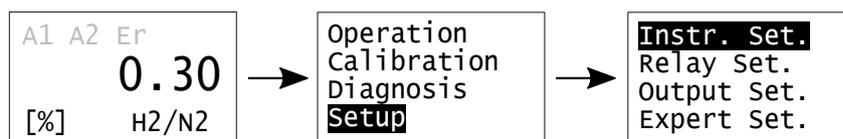
Abbildung 8.1: Setup-Menü des FTC300
